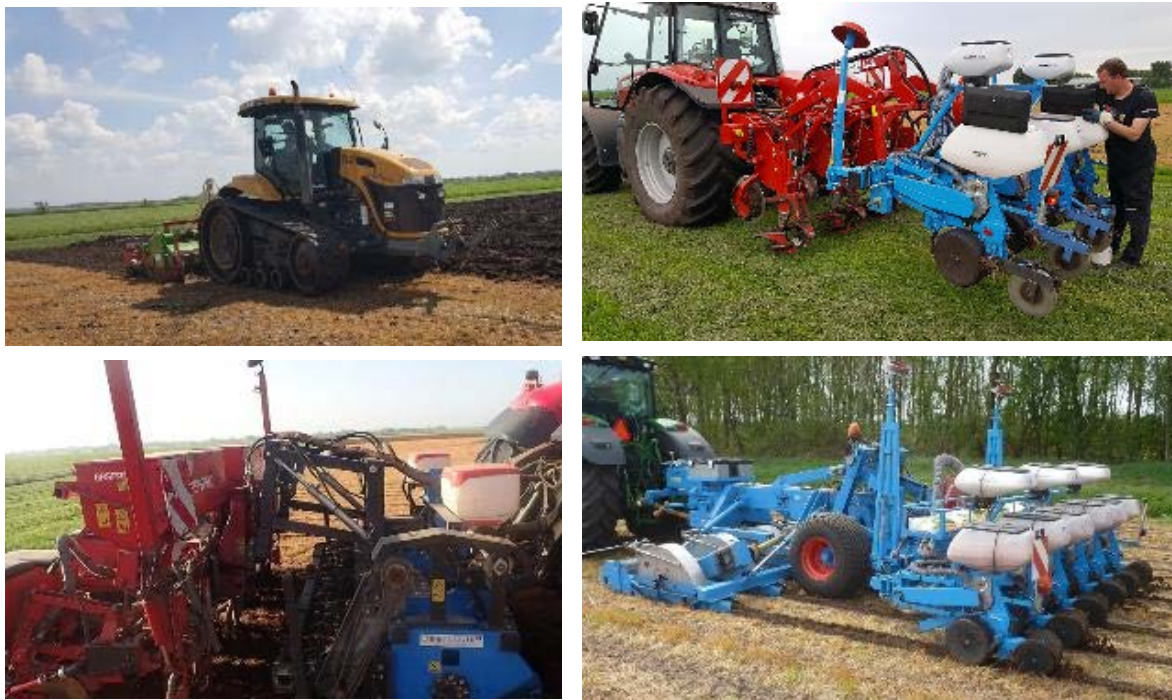
Figuur 5. Strokenteelt machines. Van linksboven naar rechtsonder: Overtopfrees, strokenfrees Hoekstra, strokenploeg Hielkema, strokenfrees Zandvliet. Voor strokenfrees BUMA zie Figuur 4.
