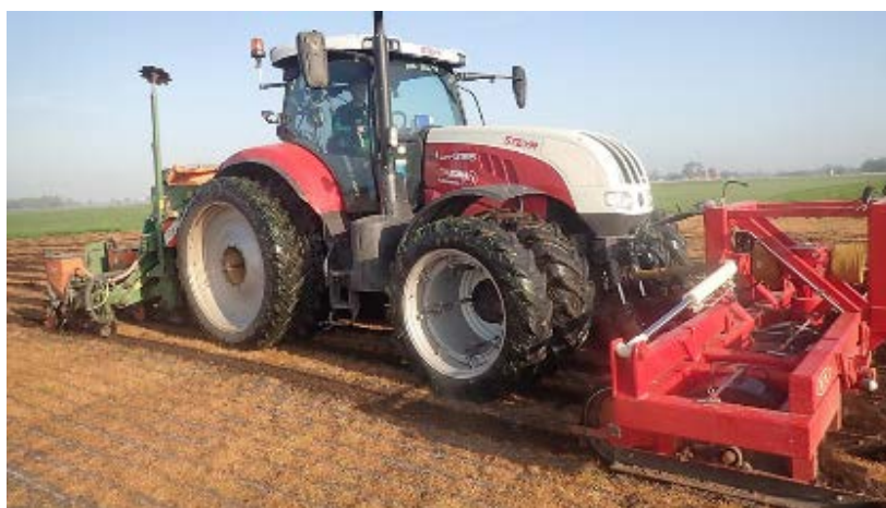
Figuur 3. Strokenfrees machine combinatie van BUMA, gebruikt voor inzaai van systeem 3 en 4.
