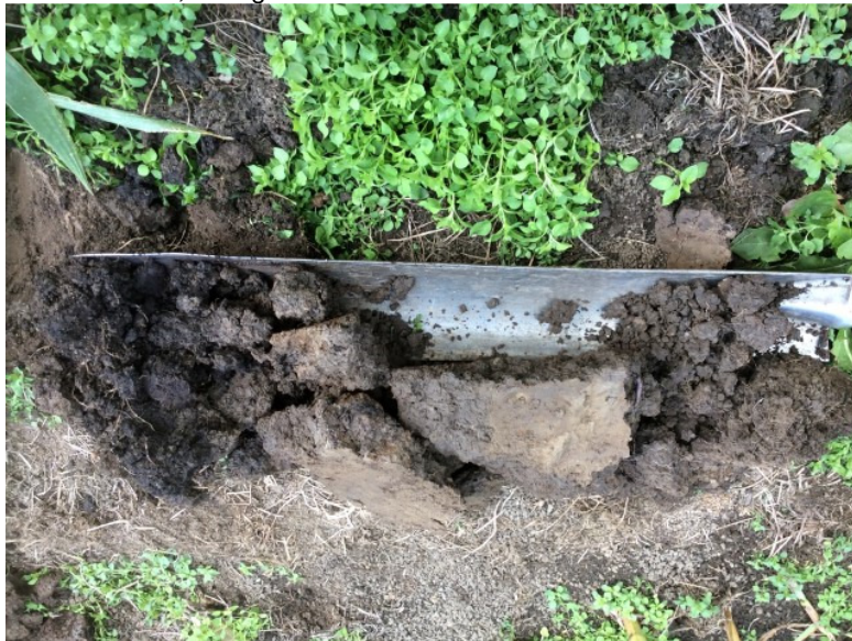
Figuur 3 in het midden de droge en vaste kleilaag, daaronder zit beworteld veen (links op de foto)
