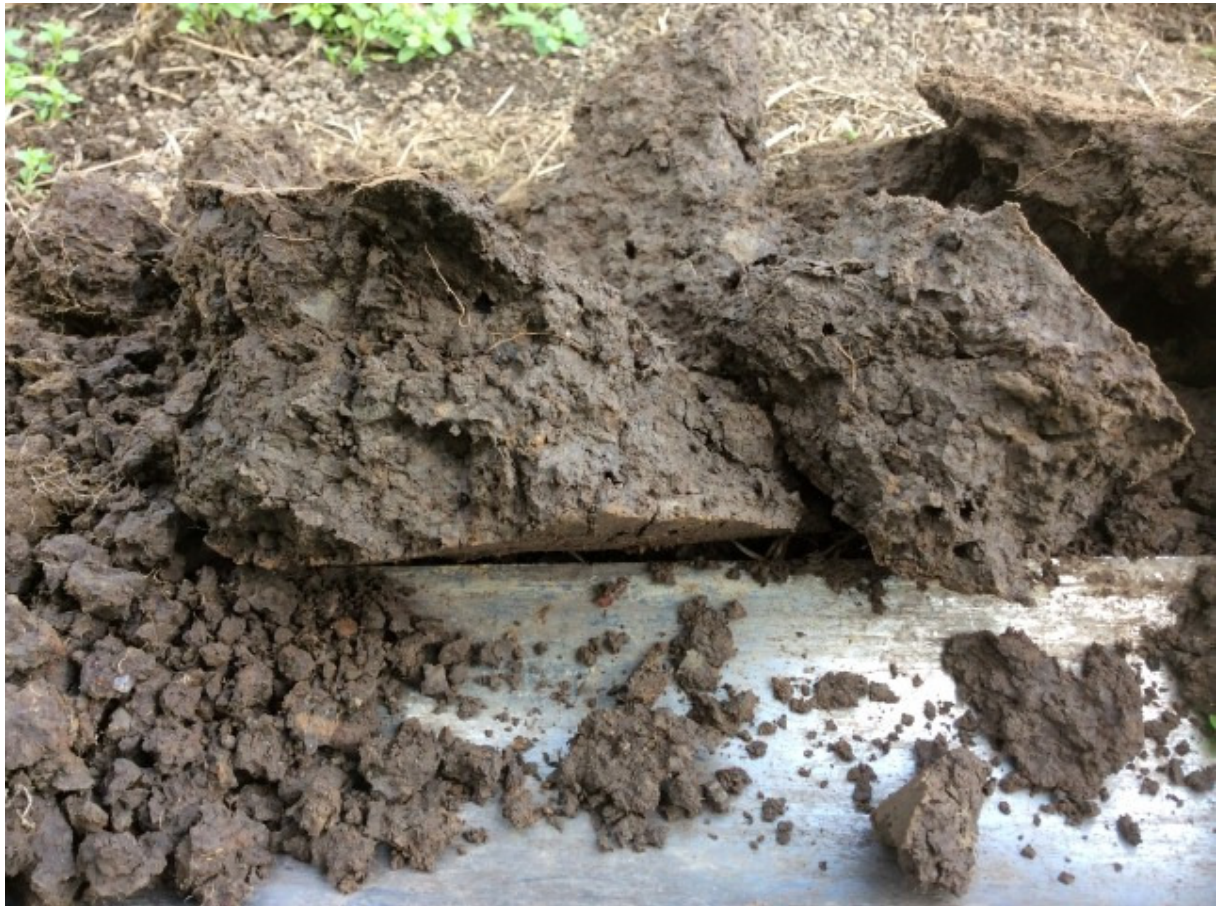
Figuur 4 de kleilaag is zeer poreus en beworteld
