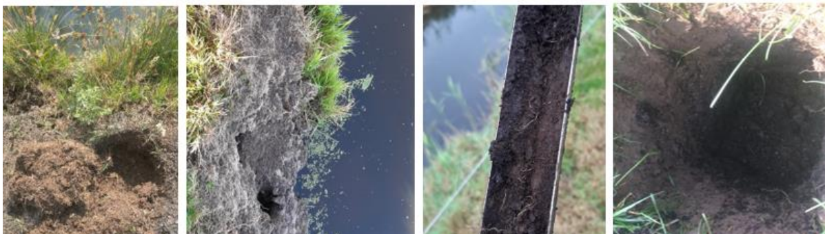
Figuur 4-8. Foto's van de verschillende bodemsoorten. 1) droog kleig veen wat snel afbrokkelt. 2) vertrapping door ganzen op klei-op-veen. 3) Typische bovengrond van weideveen. 4. Klei-op-veen profielkuil.
