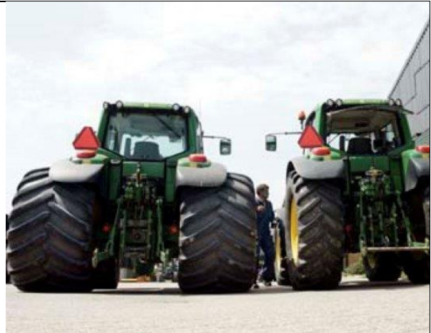
Met brede banden wordt het gewicht verdeeld over een groter oppervlak en is er kans op minder verdichting
