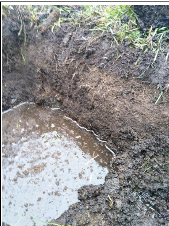
Veen wat slecht herbevochtigd in de winter van 2019. Zichtbaar is dat de bovenste 5 cm vochtig is en een laag tussen 5 en 15 cm –mv. droog (waterafstotend) is, terwijl het grondwater op 20 cm –mv. staat.
