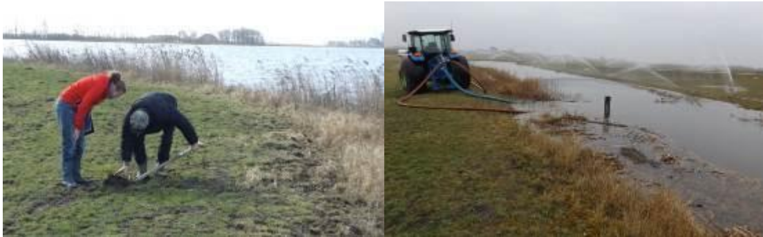
Figuur 4.8 Uitvoering van de spadeproef in Indyk (links) en veldexperiment met gesimuleerde extreme weersomstandigheden door beregening (140 mm in 4 dagen) en peilverhoging (45 cm) in Pikesyl (rechts).
