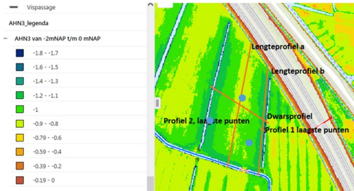
Figuur 1: Uitwerking profielen en locaties grondboringen bij B Mulder. Met de blauwe punten zijn de locaties van de boringen benaderd, die kunnen in veld op andere locatie worden gekozen in samenspraak met betrokkenen. Het slootpeil is hier 1.80 – NAP. Voor overige locaties, zie bijlage 2.
