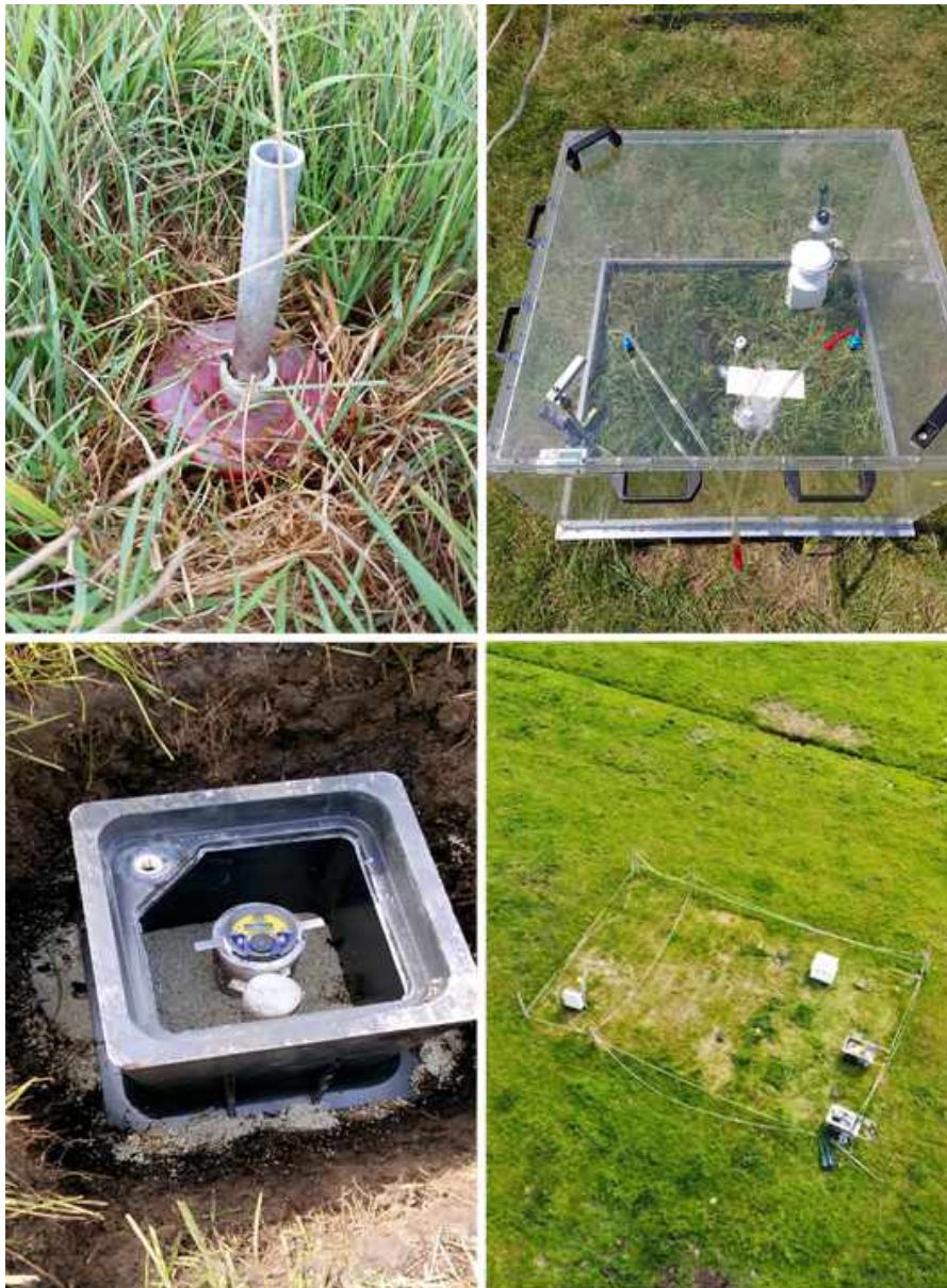
Figuur 2.3 Links boven: Een metalen pin die vaststaat in de onderliggende zandlaag. Rechtsboven: Een transparante meetkamer die gebruikt is voor CO 2 fluxen. Linksonder: Peilbuis met grondwaterstand telemetrie. Rechtsonder: Meetplot in locatie Ger-OWD tijdens een meetdag.
