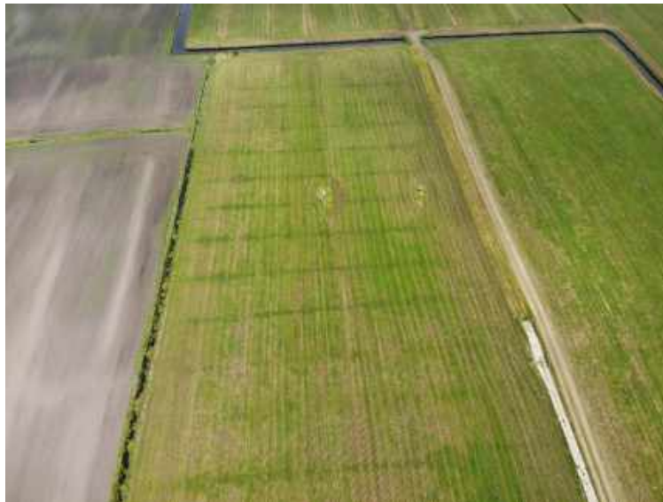
Figuur 3.27 Overzichtsfoto van het perceel met drukdrainage. Donkergroene banden tonen waar de oude drainagebuizen liggen. Afstand tussen de oude drainagebuizen is 15 meter.
