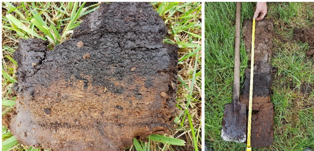
Fig. 4.1. Bodemprofiel boring 31 met duidelijke grens veraard (zwart) en niet-veraard veen (bruin)
