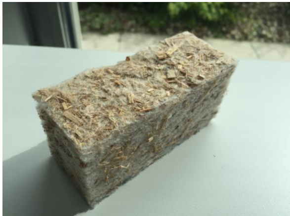
Figuur 3.1. Een proeve van isolatiemateriaal gemaakt van lisdodde.
