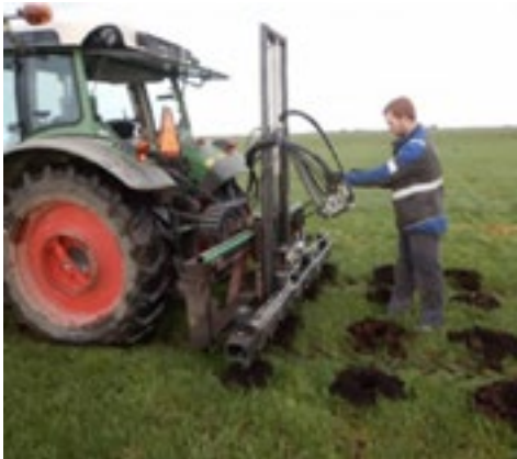
Boren van de gaten in de onderzoeksplots Links het boren van de gaten met de machine van Wageningen Plant Research. Rechts geboorde gaten in object D (dubbel aantal) vlak na het boren. Foto: Louis Bolk Instituut
