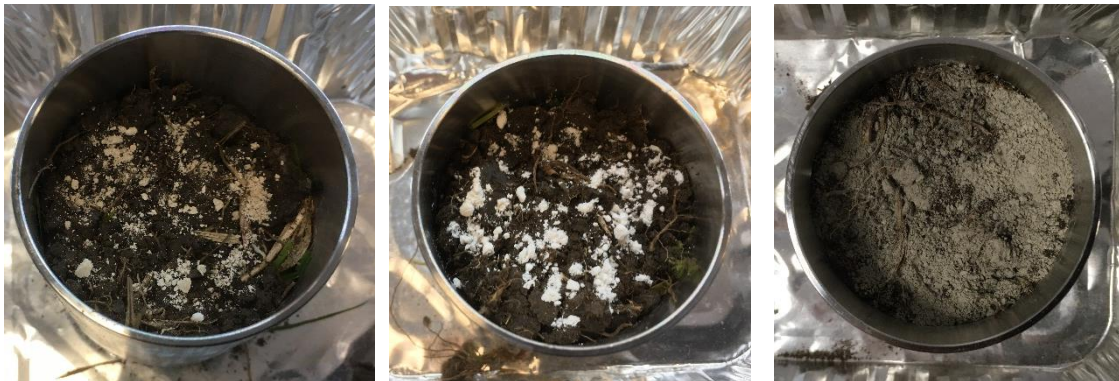
Figuur 3. Toevoegen van a) kalk, b) gips en c) klei aan de ringen (hier bodem GV-g)
