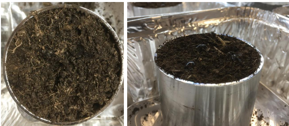
Figuur 2. Bulkdichtheidsringen met bodemmonsters. a) bovenaanzicht, b) als druppels langer dan 10 seconden blijven liggen is dat een teken dat de grond hydrofoob is.
